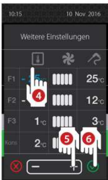
Bildschirmanzeige Erweiterte Einstellungen mit Kernfühler (automatisch)
